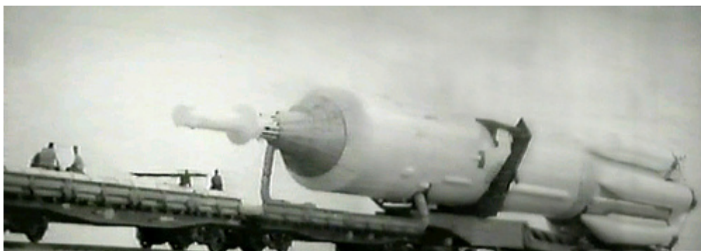
ТКС на ракете-носителе "Протон", шпиль слева - система спасения
